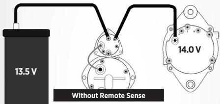
Remote Sense utiliza un segundo cable que lee el voltaje real en la batería. Esto señala al alternador para aumentar su salida para compensar la caída de voltaje, asegurando 14 voltios en la batería. El voltaje apropiado fuerza más corriente en la batería llevándola a un estado completo de carga entre paradas del vehículo.
